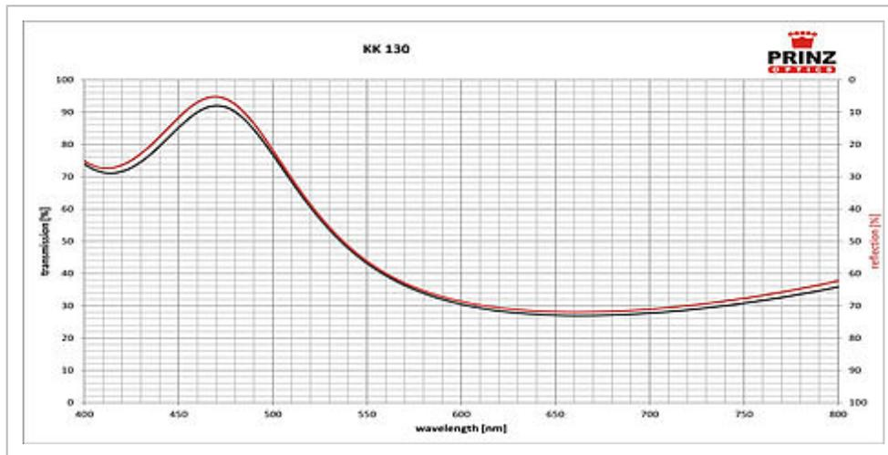
Mit den Konversionsfiltern von PRINZ OPTICS kann die Farbtemperatur eines Temperaturstrahlers erhöht bzw. gesenkt werden. Wir bieten eine breite Palette fein abgestufter Konversionsfilter in beide Richtungen (CTO und CTB). Weiterhin gewährleistet BOROFLOAT® als Substratmaterial eine hohe Temperaturbelastbarkeit und Gebrauchsfestigkeit.
