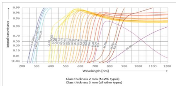
SCHOTT-Langpassfilter, auch als Kantenfilter bezeichnet, besitzen eine steile Absorptionskante. Dies erlaubt eine scharfe Trennung zwischen Sperr- und Transmissionsbereich. Die Filter arbeiten nahezu winkelunabhängig.
